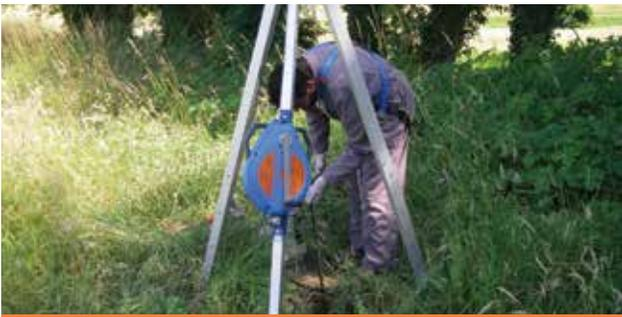
Mise en place du matériel pour la mesure du débit dans le réseau.
